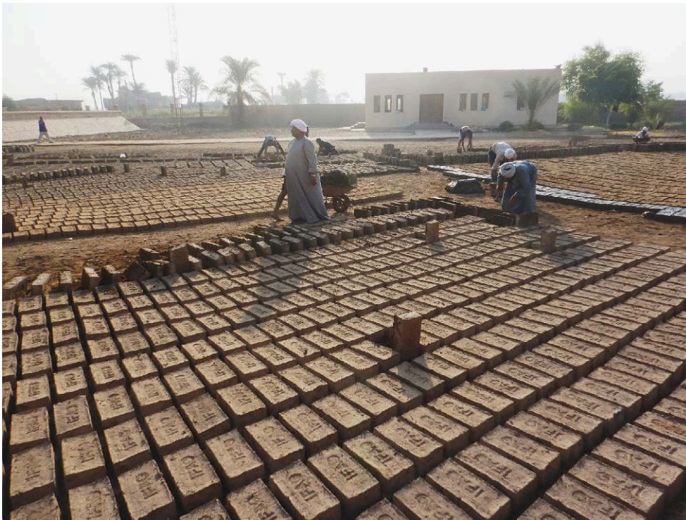
Fig. 1. Production locale de plus de 40 000 briques, à l'est du téménos d'Hathor (M. Vanpeene).
