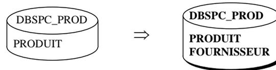
**Figure 4.10** - Ajout de la table *FOURNISSEUR* dans l'espace de stockage *DBSPC\_PROD*.
