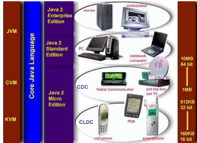
FIG. 2.1 – Correspondances entre les types d'appareils et les plate-formes adaptées
