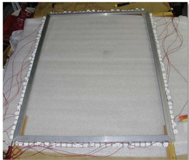
Figure 6.5 : Les 126 LED infrarouges connectées autour de la plaque d'acrylique.
