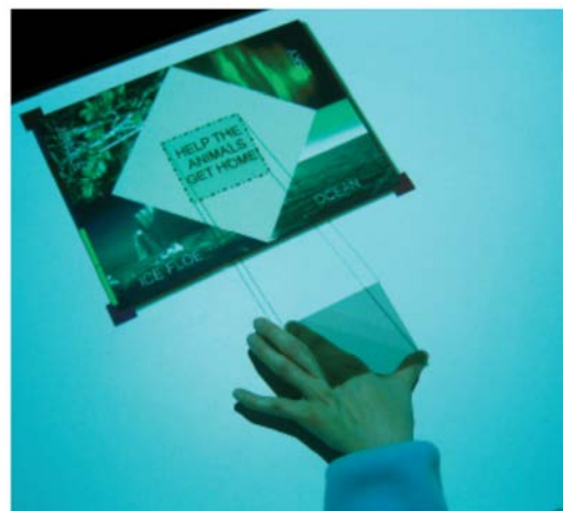
Figure 5.15 : Sélection à distance d'une partie d'une image en évitant l'occlusion sur celle-ci. Source : [Shen, et al., 2006, p. 38]
