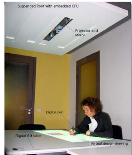
Figure 4.7 : Virtual Desktop, table pour dessin assisté par ordinateur pour architectes. Source : [Safin, Boulanger, & Leclercq, 2005, p. 2]
