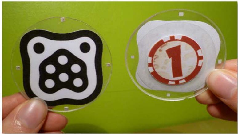
Figure 7.13 : Objets tangibles (jetons de paris) - A gauche le tag reconnu par reactIVision et collé en-dessous de l'objet ; A droite vue du dessus avec l'étiquette de couleur.
