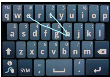
Figure 5.12 : Le mot "the" encodé sur le clavier gestuel Swype (QWERTY). Source : [Castellucci & MacKenzie, 2011, p. 1510]
