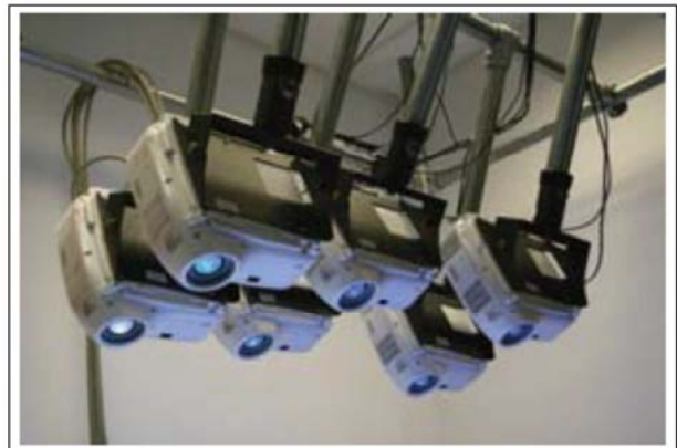
Figure 5.3 : Six projecteurs comme périphérique de sortie. Source : [Ashdown, Tuddenham, & Robinson, 2010, p. 78]
