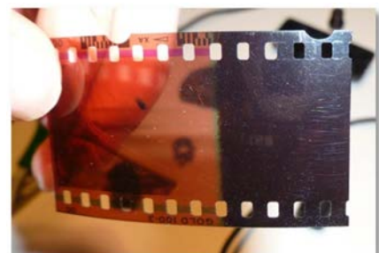
Figure 6.9 : Film argentique de photo utilisé comme filtre de lumière visible (partie « noircie »).
