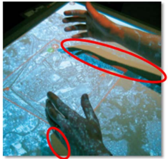
Figure 5.14 : Occlusion sans interaction avec projection avant.
