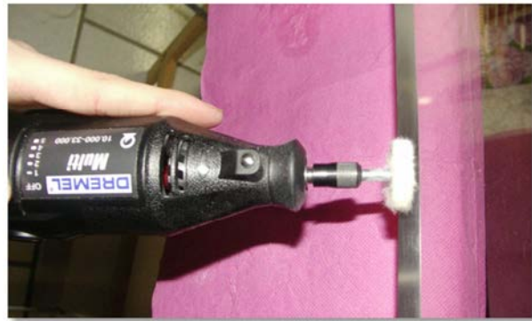
Figure 6.2 : Polissage avec une ponceuse électrique des côtés de la plaque de Plexiglass.
