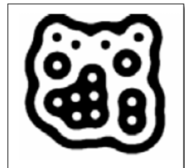
Figure 1.7 : Exemple de « fiducial marker » (tag) collé sur un objet tangible afin qu'il soit reconnu par la reacTable.
