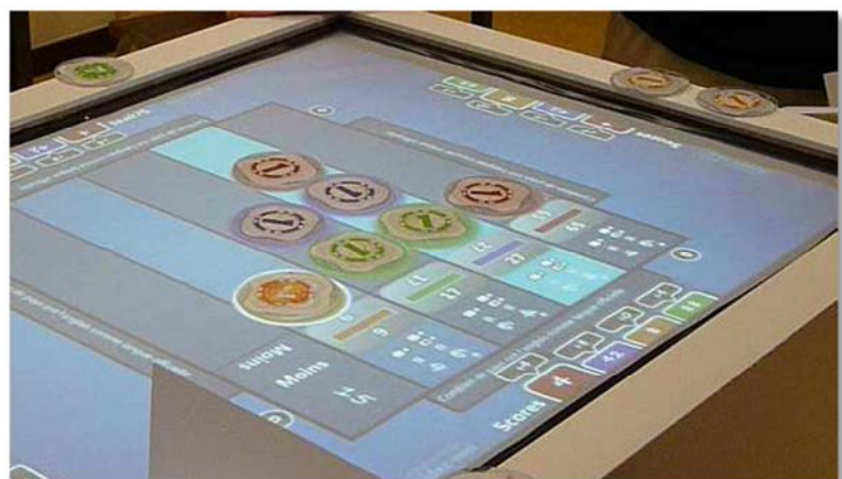
Figure 7.14 : Objets tangibles sur la table avec retour visuel directement sous ceux-ci.
