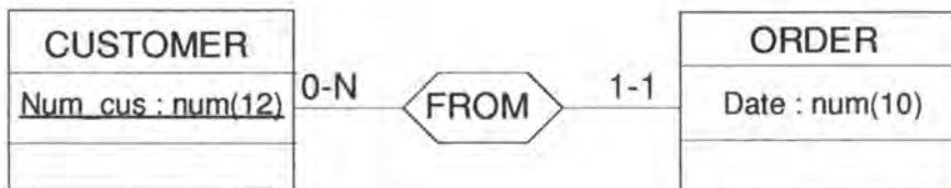
Fig. 4.4 : Illustration du concept d'identifiant.
