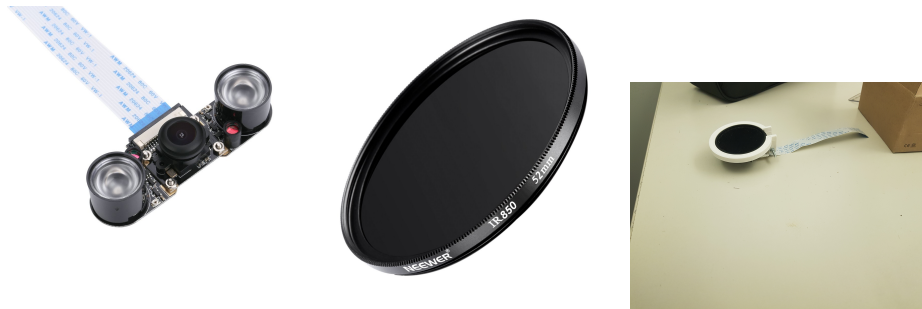
FIGURE 6.4 – En fixant le filtre devant la caméra, la caméra ne voit plus que les éléments qui apparaissent dans la lumière infrarouge
