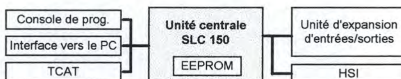
~ Figure 3.5 : Composants utilisables avec l'automate SLC 150 ~
