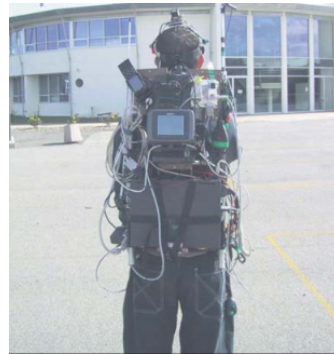
FIGURE 7 – Ordinateur utilisé pour ARQuake - [PIEKARSKI et THOMAS, 2002]
