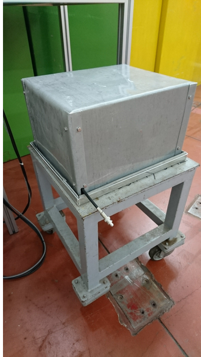
FIGURE 10.1 – Photographies du blindage passif additionnel fait de 2 mm de cadmium.
