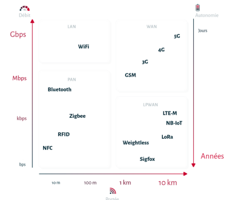
FIGURE 2.3 – Caractéristiques des réseaux IoT [36]
