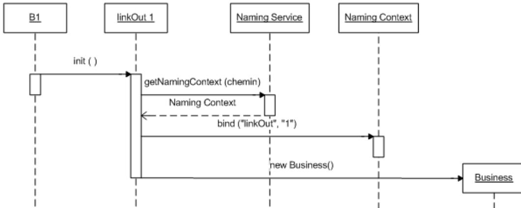
FIG. 3.9 – Enregistrement de la référence d'un connecteur out.
