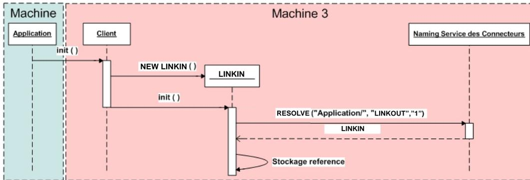
FIG. 3.23 – Initialisation d’une variable de type *Client*.
