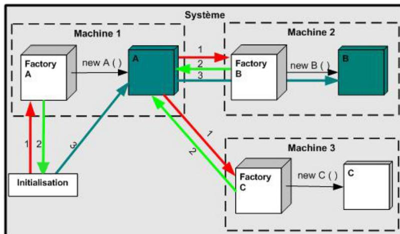
FIG. 3.13 – Déploiement et initialisation des variables.
