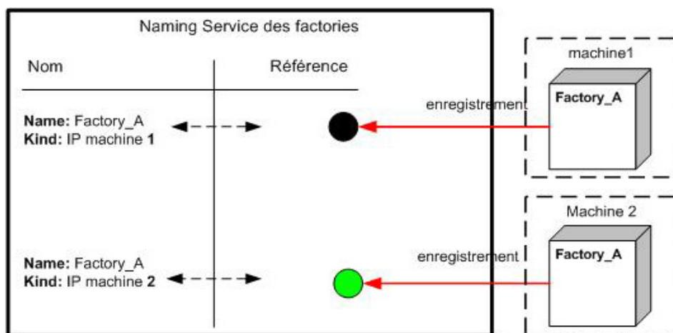
FIG. 3.15 – Enregistrement de factories dans le naming service.
