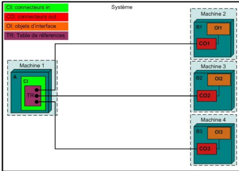
FIG. 3.16 – Connexion manytoone entre deux ensembles d'instances.
