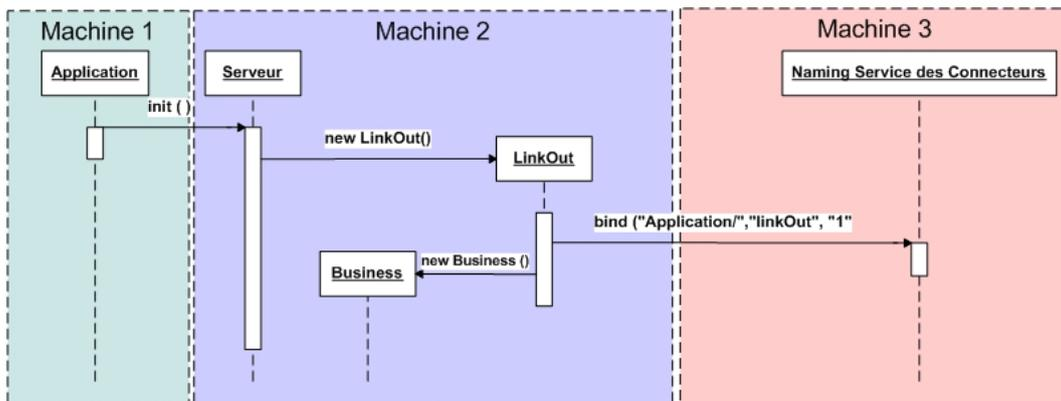
FIG. 3.24 – Initialisation d’une variable de type *Server*.
