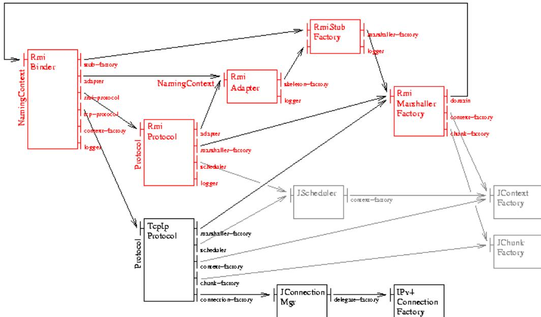
FIG. 5.1 – Architecture du modèle Fractal RMI.
