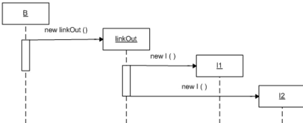
FIG. 3.10 – Création des objets d'interfaces d'un composant.
