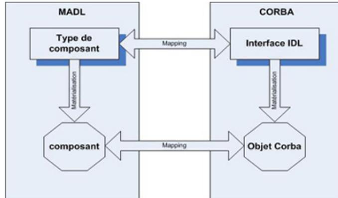
FIG. 3.1 – Correspondance entre le type de composant et l’interface IDL.
