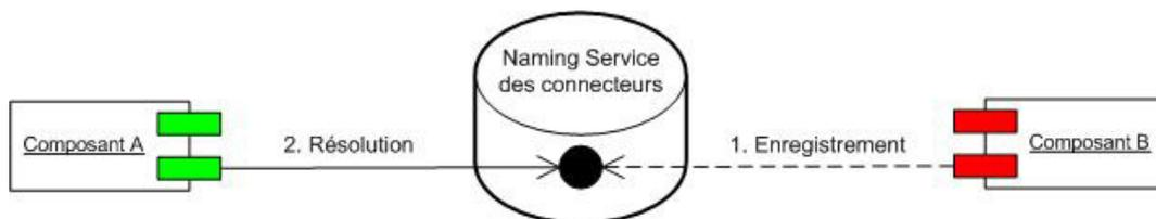
FIG. 3.4 – Utilisation du naming service des connecteurs
