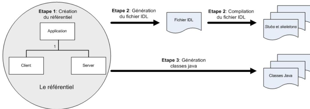
FIG. 4.1 – Etapes du développement du prototype.
