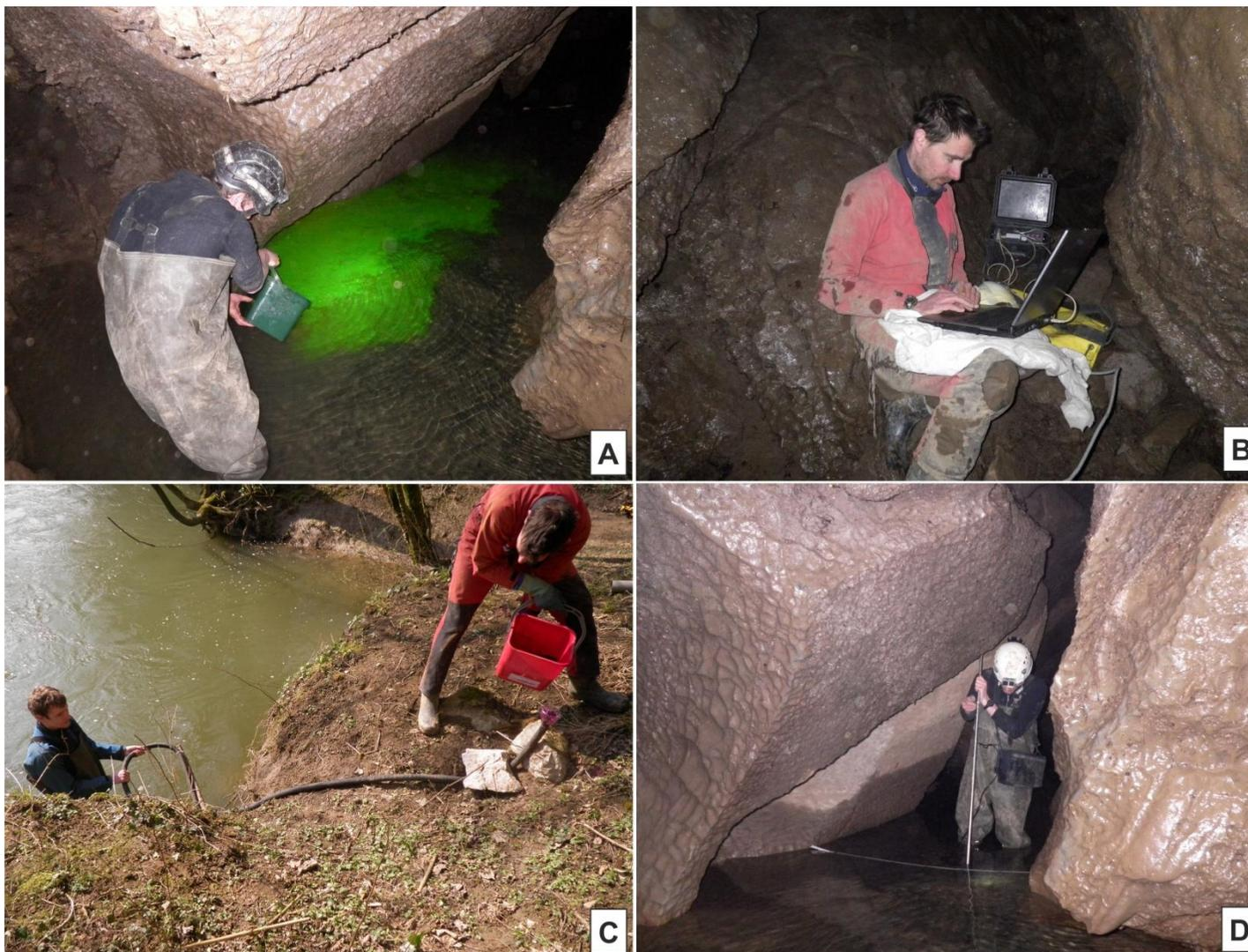
Planche 1 : Photographies – A : Injection d'uranine à la Galerie des Sources (G. Rochez), B : Relevé d'un fluorimètre de terrain, C : Injection de rhodamine dans le Chantoir des Nutons (L. Dewaïde), D : Jaugeage de la rivière souterraine à la Galerie des Sources (G. Rochez).
