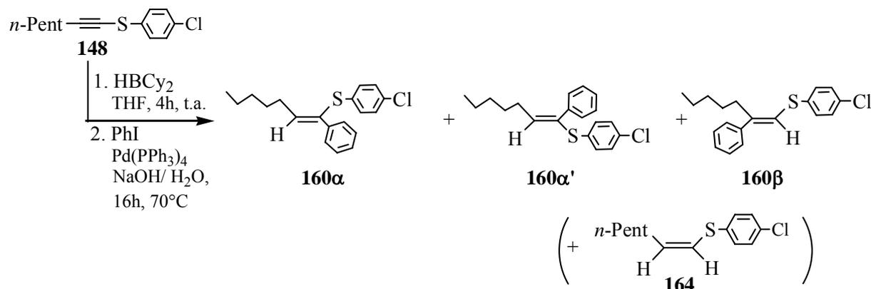
La procédure représentative **PR4** est reproduite, en utilisant 0.404 ml de cyclohexène (d : 0.811, 328 mg, 4 mmol), 2 ml de BH<sub>3</sub>-THF (1.0 M dans le THF; 2 mmol), 478 mg de 1-(4-chlorophénylthio)-1-heptyne **148** (2 mmol).
