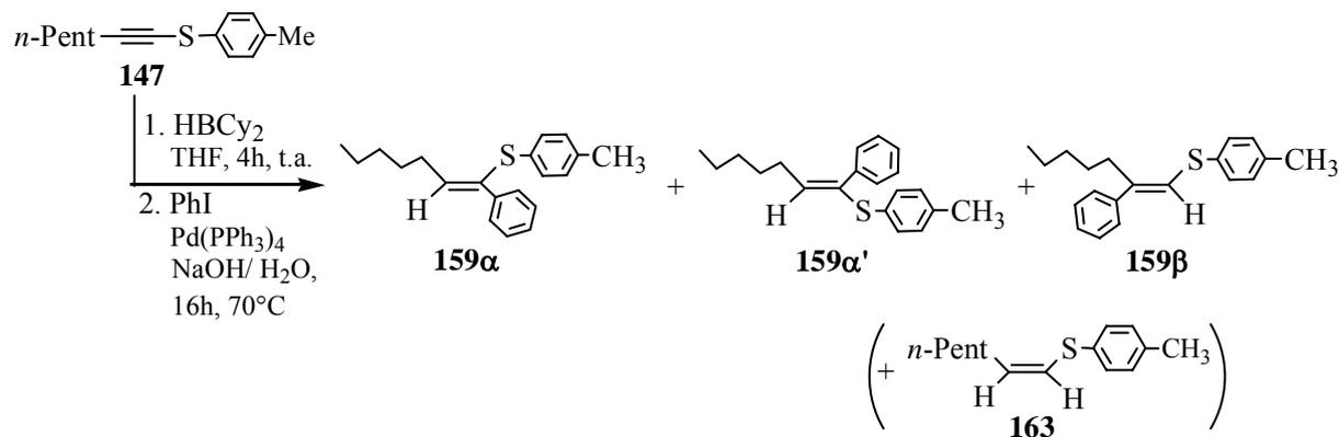
La procédure représentative **PR4** est reproduite, en utilisant 0.404 ml de cyclohexène (d : 0.811, 328 mg, 4 mmol), 2 ml de BH<sub>3</sub>-THF (1.0 M dans le THF; 2 mmol), 436 mg de 1-(p-tolylthio)-1-heptyne **147** (2 mmol).
