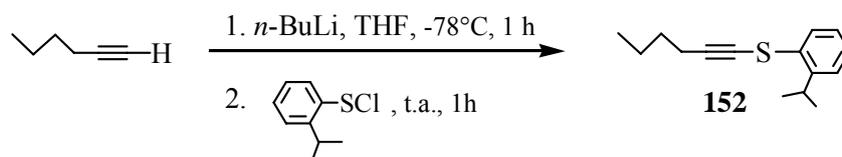
La procédure représentative **PR3** est reproduite, en utilisant 410 mg de 1-hexyne (5 mmol), 3.2 ml de *n*-butyllithium (1.6 M dans l'hexane ; 5.1 mmol) et le chlorure de 2-*isopropylphénylsulfényle* (5 mmol). La purification par chromatographie sur silice (éluant : pentane) fournit 963 mg de l'alcyne **152** (Rdt : 83 %).
