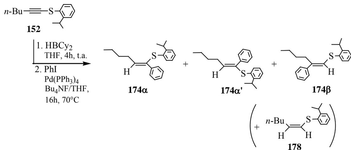
La procédure représentative **PR4** est reproduite, en utilisant 0.404 ml de cyclohexène (d : 0.811, 328 mg, 4 mmol), 2 ml de BH<sub>3</sub>-THF (1.0 M dans le THF; 2 mmol), 464 mg de 1-(*isopropyl*phénylthio)-1-hexyne **152** (2 mmol).
