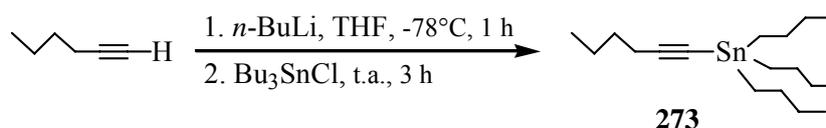
La procédure représentative **PR3** est reproduite, en utilisant 820 mg de 1-hexyne (10 mmol), 6.3 ml de *n*-butyllithium (1.6 M dans l'hexane ; 10.1 mmol) et 3.255 g de chlorure de tri(*n*-butyl)stannyle (10 mmol) dissous dans 10 ml de THF. Les purifications successives par distillation (de façon à éliminer les dérivés stannylés légers) puis par chromatographie liquide sur silice (éluant : pentane) fournit 2.402 g du composé **273** (**Rdt** : **65 %**).
