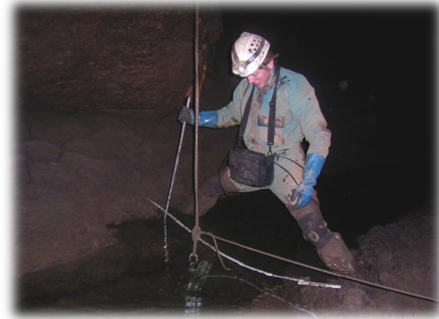
8. Installation d'un fluorimètre de terrain à la salle Cornet
