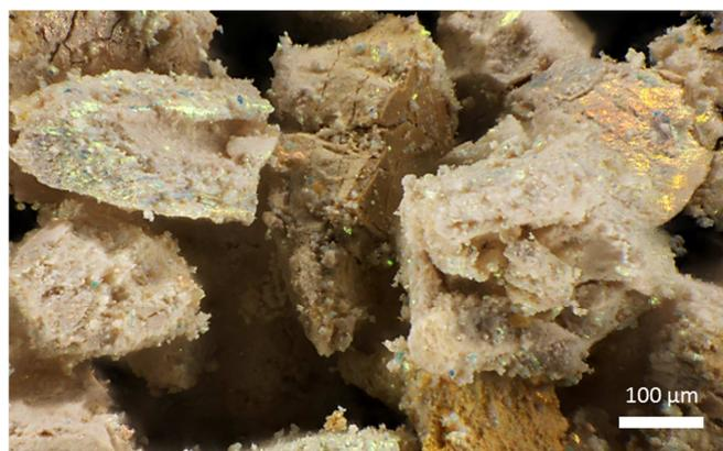
Figure 6.1 : Microscopie optique d'une opale inverse dopée à 3 At.% en vanadium, forte iridescence jaune-orangé, taille de sphère de 265 nm de diamètre.
