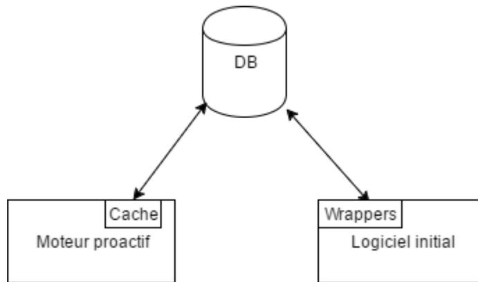
FIGURE 4.5 – La vérification des modifications sur une base de données depuis le moteur proactif
