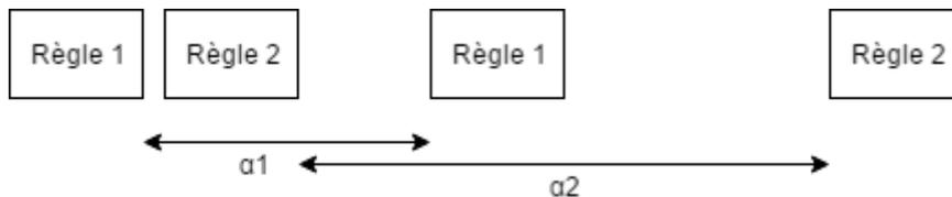
FIGURE 4.12 – Le paramètre alpha entre deux exécutions d'une règle.
