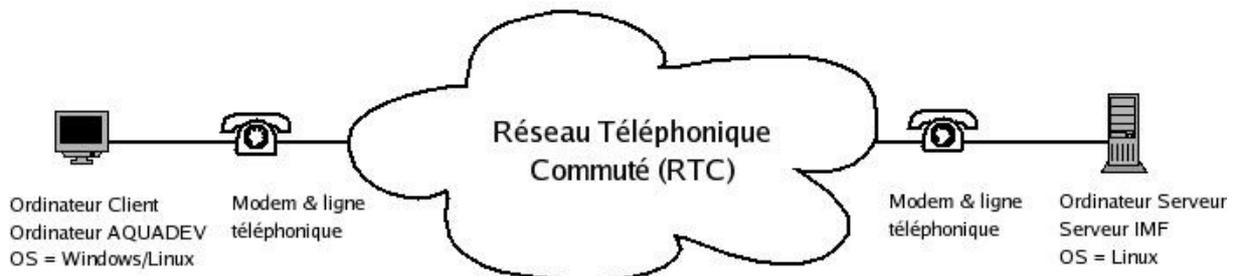
Fig. 4.1 – Déploiement envisagé de la solution d'accès à distance
