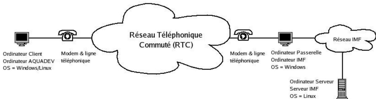
Fig. 4.1 – Déploiement alternatif de la solution d'accès à distance
