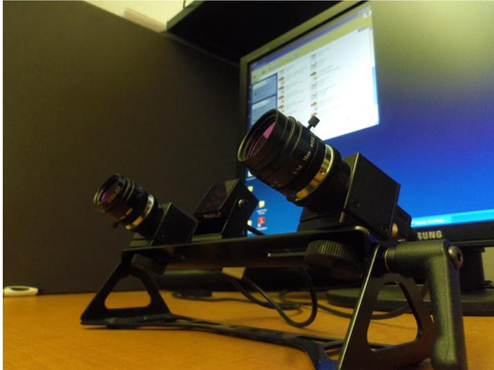
FIGURE 7.1 – L’oculomètre FaceLAB de l’École Polytechnique de Montréal
