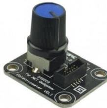
Figure 9 : Potentiomètre .Net Gadgeteer (résistance variable)
