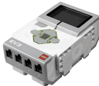
Figure 7 : La brique programmable Lego Mindstorms EV3
