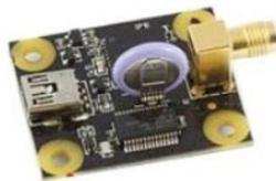
Figure 3 : Carte Phidget GPS avec connectique USB
