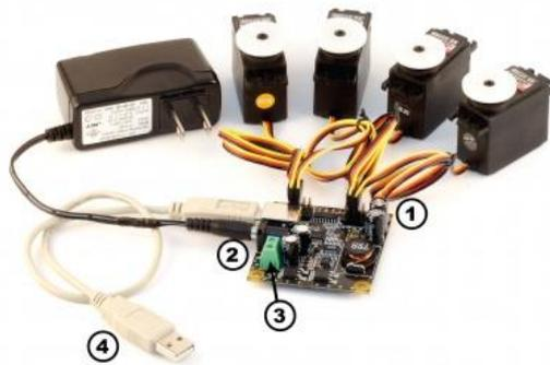
Figure 5 : carte Phidget avec plusieurs servomoteurs connectés
