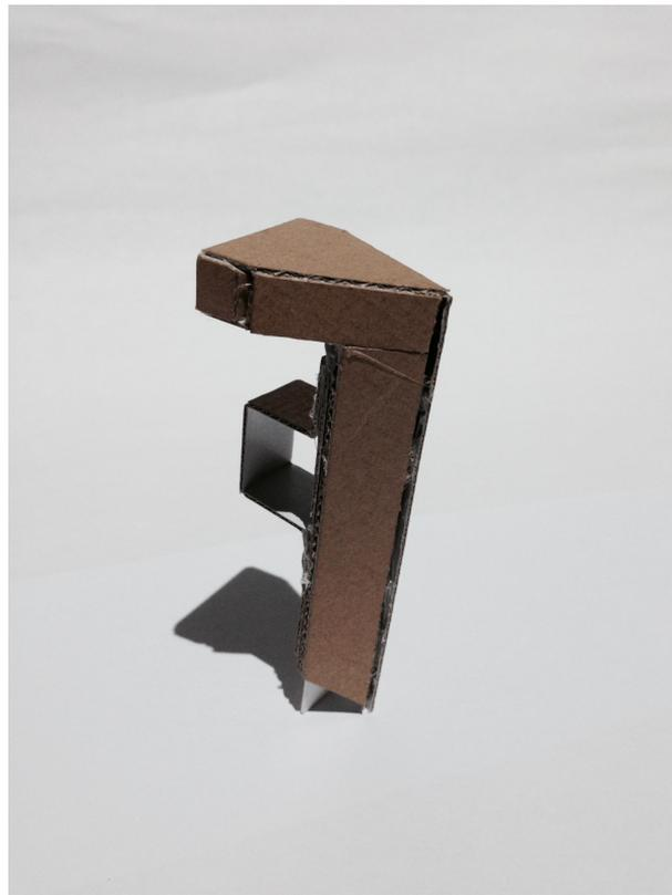
FIGURE 10.1: Le prétype en carton du contrôleur utilisé pour évaluer son ergonomie d'utilisation
