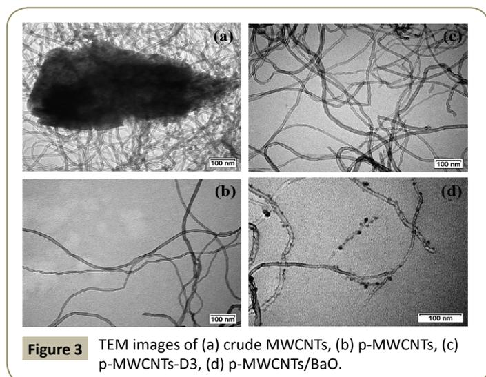
Figure 3 TEM images of (a) crude MWCNTs, (b) p-MWCNTs, (c) p-MWCNTs-D3, (d) p-MWCNTs/BaO.
