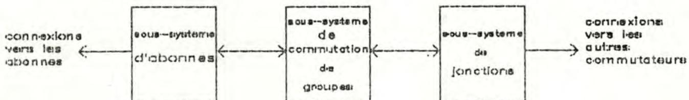
figure T10 : sous-systèmes de connexion et de commutation.
