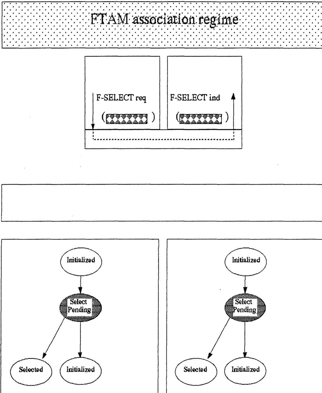
Figure 5 : communication d'une primitive d'indication FTAM.
