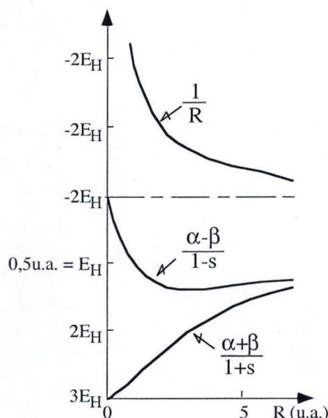
FIGURE 10 : Dépendance radiale des énergies d'orbitales
