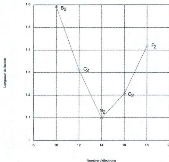
FIGURE I 4 Évolution de la longueur de liaison des molécules diatomiques en fonction du nombre d'électrons
