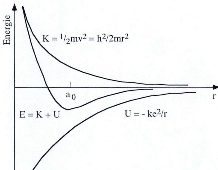
FIGURE 5 : Énergie cinétique (**K**) d'après le principe d'incertitude, énergie potentielle **U** et énergie totale **E**, dont le minimum définit les "dimensions" de l'atome :  $a_0 = 0,529 \text{ \AA}$
