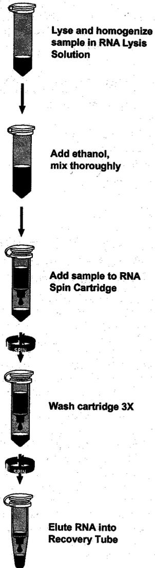
Figure 3 : Schéma illustrant l'extraction de l'ARN total suivant le kit *Micro-to-Midi Total RNA Purification System*, Invitrogen, Carlsbad, USA.
