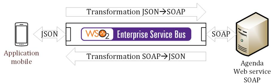
FIGURE 5.2 – Concept d'un scénario d'intégration dans WSO2 ESB.
