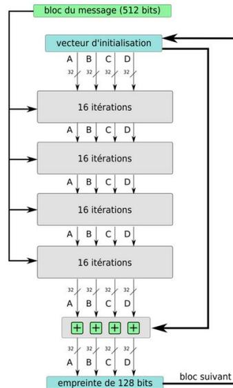
FIGURE 12 – Représentation de l’algorithme de hachage MD5. (WIKIPÉDIA 2020)
