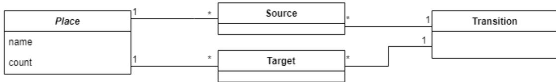
FIGURE 8 – Métamodèle de réseau de Petri
