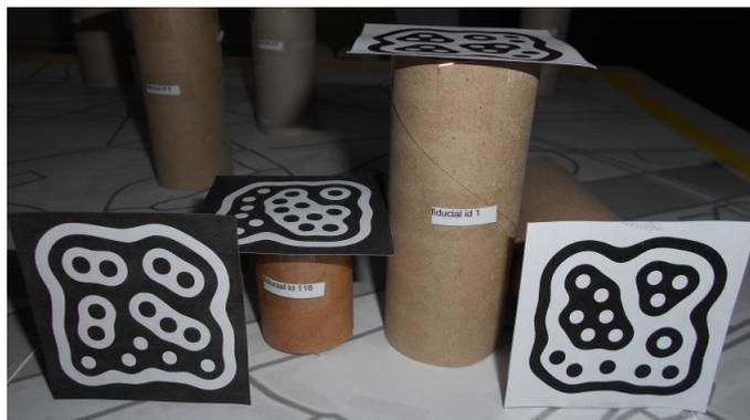
**FIGURE 19** – Le mockup des objets tangibles. Des objets de taille réduite, aux marqueurs noirs, sont utilisés pour représenter les filtres (à gauche). Des objets de taille plus élevée, aux marqueurs blancs, représentent les infrastructures (à droite).
