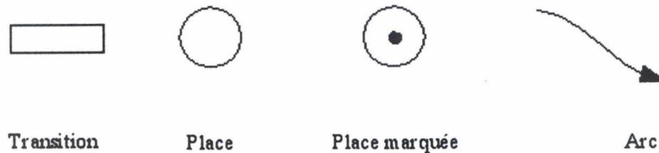
FIG. 9.6 – Concepts de base d'un réseau de Petri
