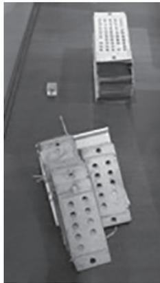
Figure 2 : Cartes perforées destinées à la Machine analytique de Babbage : celles destinées aux opérations, à l'avant-plan; les autres, à l'arrière-plan<sup>62</sup>.
