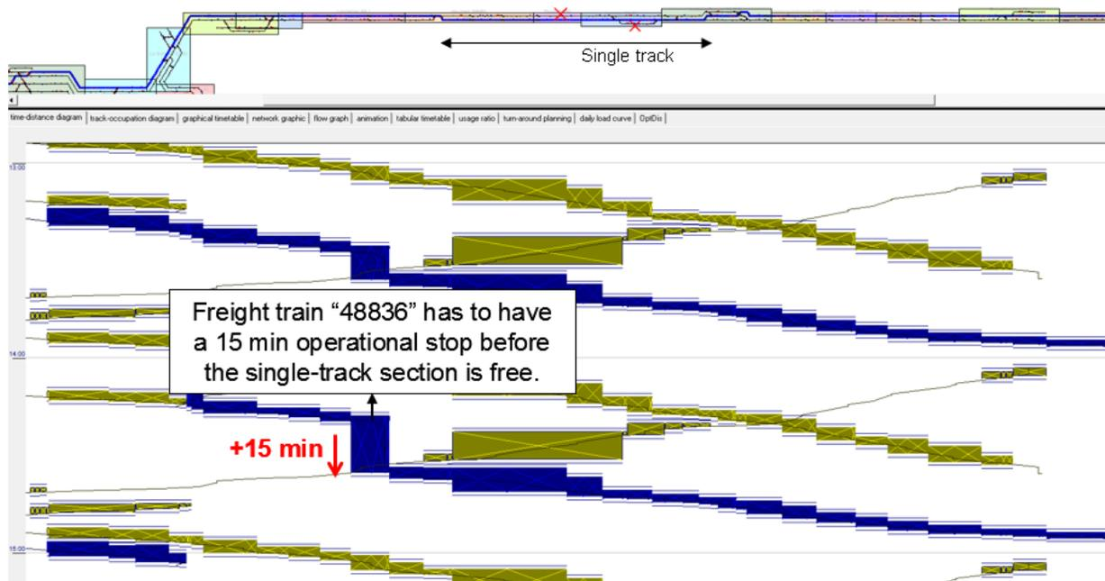
Figure 11 : Interface de LUKS utilisée pour l'analyse de la circulation des trains sur le réseau Infrabel. Dans la partie supérieure de l'écran et sur l'axe X : la représentation d'une ligne. Sur l'axe Y, le temps. Chaque bloc sur le diagramme représente l'occupation d'une section par un train.
