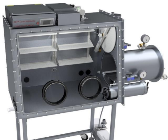
Figure 16 - Boite à gants de type GC(Campus) de la marque Jacomex.
