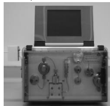
Figure 14 - Réacteur H-Cube® de ThalesNano.
