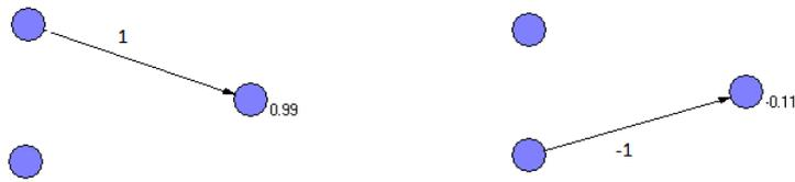
FIGURE 5.23 – Architectures des réseaux modélisant les fonctions logiques à deux entrées (1). Les architectures présentées ne contiennent qu'une seule connexion d'une des entrées à la sortie. Le réseau de gauche représente la fonction  $f_1$  et l'entrée reliée à la sortie est la première. Au contraire, l'entrée reliée à la sortie dans la figure de droite est la seconde. La fonction modélisée est la fonction  $f_4$ .
