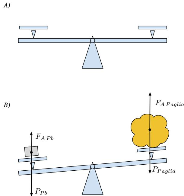
*Figura 1. Misura con una bilancia a due piatti.
