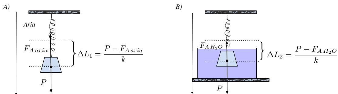
Figura 4. Pannello A): Molla vincolata al soffitto con una massa attaccata all'estremità inferiore, in presenza di aria.  $F_{A \text{ aria}}$  è la forza di Archimede (esercitata dall'aria) e  $P$  il peso del corpo.
