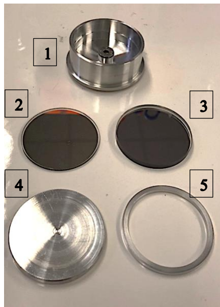
Figure 14 : Module et filtres d'exposition au vide et aux variations de température. (1) Il s'agit du module en aluminium dans lequel sont placés les répliques des échantillons. (2) Il s'agit d'un filtre OD4 qui ne laisse passer que 0,01 % d'UVs. (3) Il s'agit d'un autre filtre de type OD2. (4) Il s'agit d'une plaque en aluminium qui ne laisse pas passer d'UVs. (5) Cet anneau a été confectionné pour être positionné sur les filtres pour éviter le passage d'une concentration non voulue d'UVs au niveau des bords.
